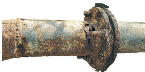
Мал. 42.4. Корозія сталевій труби унаслідок дії на метал вологи, кисню та тіонових бактерій
