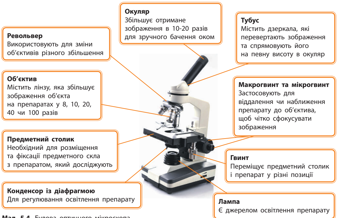
Мал. 5.4. Будова оптичного мікроскопа
